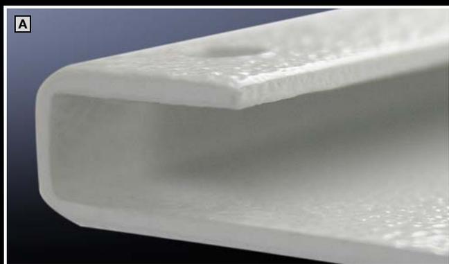
A Листовая сталь с трехступенчатой обработкой поверхности (стандарт у Rittal) после 180-часового теста в соляном тумане
